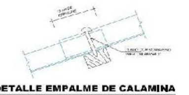
DETALLE EMPALME DE CALAMINA
