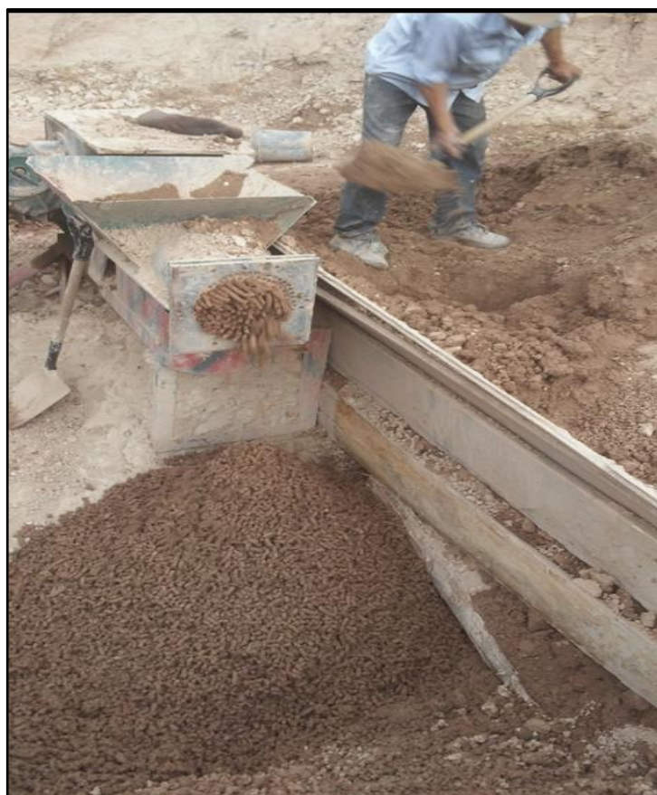
Figura V-9: Amasado con maquinaria
