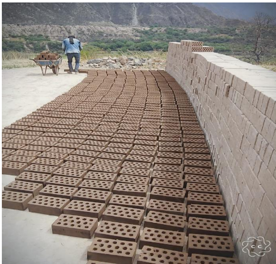
Figura V-13: Almacenamiento en pilas de ladrillos
