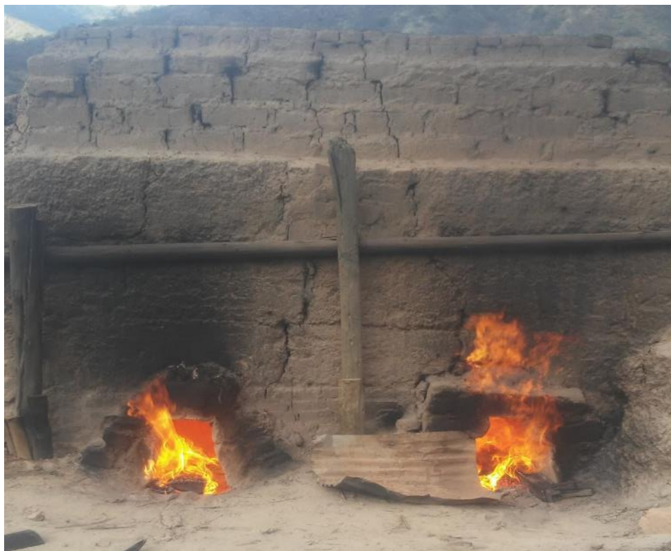
Cocción de ladrillos de arcilla
