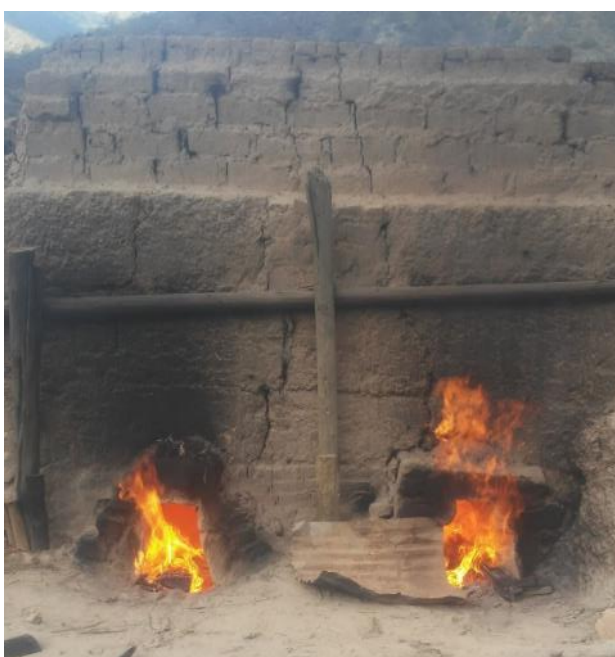
Figura V-14: Cocción de ladrillos
