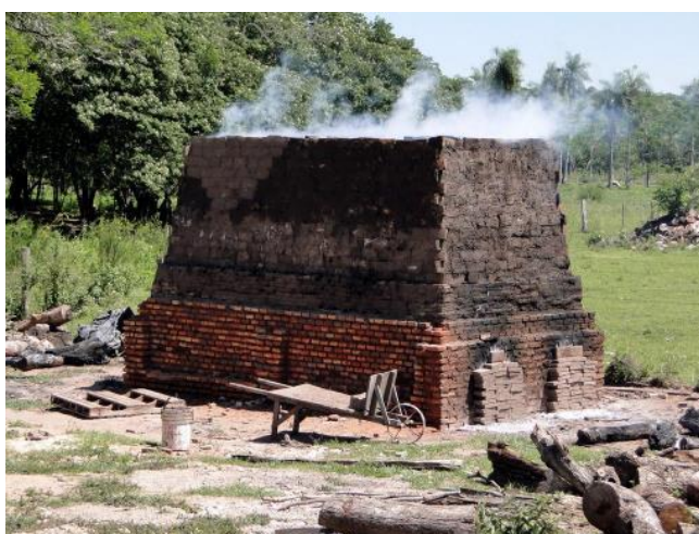
Figura II-8: Quemado de ladrillos en horno vertical
