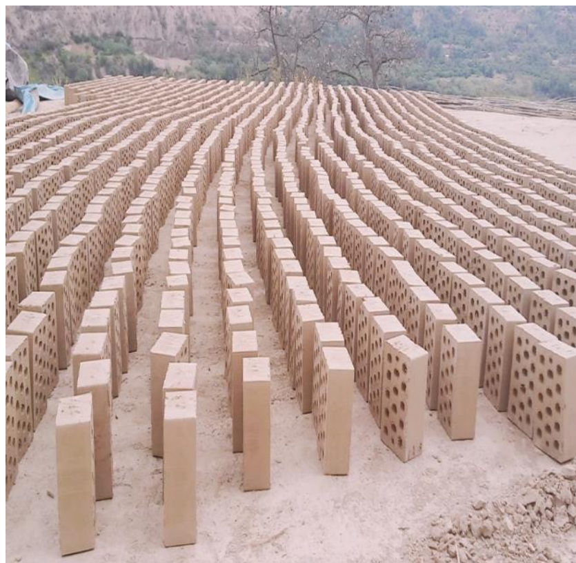
Figura V-12: Secado de ladrillos a aire libre
