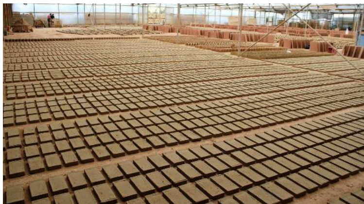
Figura II-7: Secado de ladrillos
