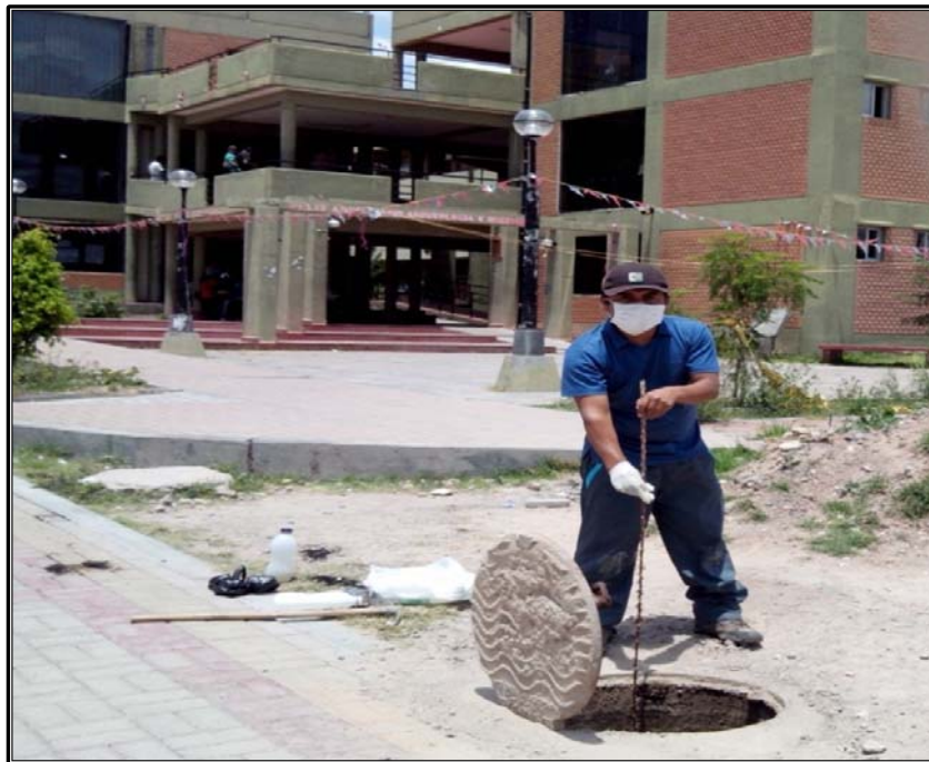
Fotografía N° 06: Recojo de Muestreo de aguas residuales en el Bz – 02 (Facultad de Ciencias Sociales)
