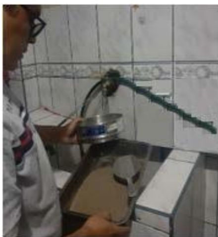
Ilustración 13. Prueba de granulometría en laboratorio C-1, C-2, C-3
