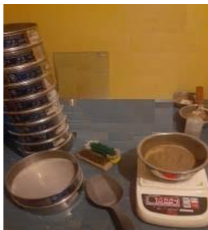
Ilustración 13. Prueba de granulometría en laboratorio C-1, C-2, C-3
