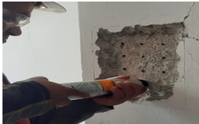
Fotografía 6. Columna-Pulsación del esclerómetro Fuente: Propia
