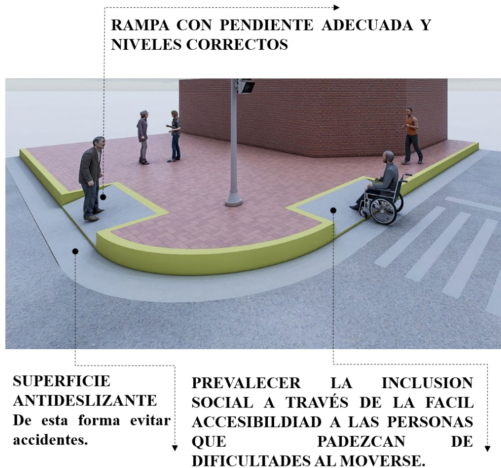
Figura 45. Características de la Rampa
