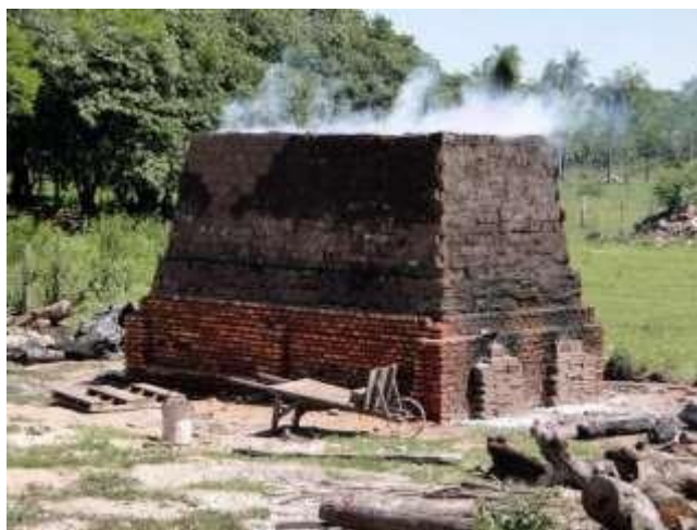
Figura II-8: Quemado de ladrillos en horno vertical
