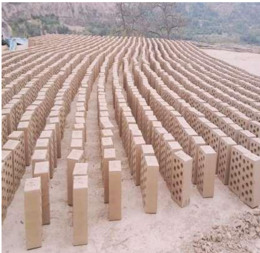
Figura V-12: Secado de ladrillos a aire libre
