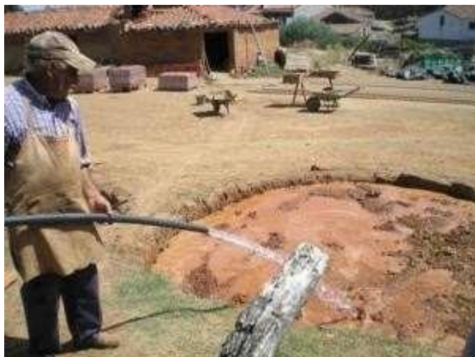
Figura II-5: Preparación de masa para ladrillo
