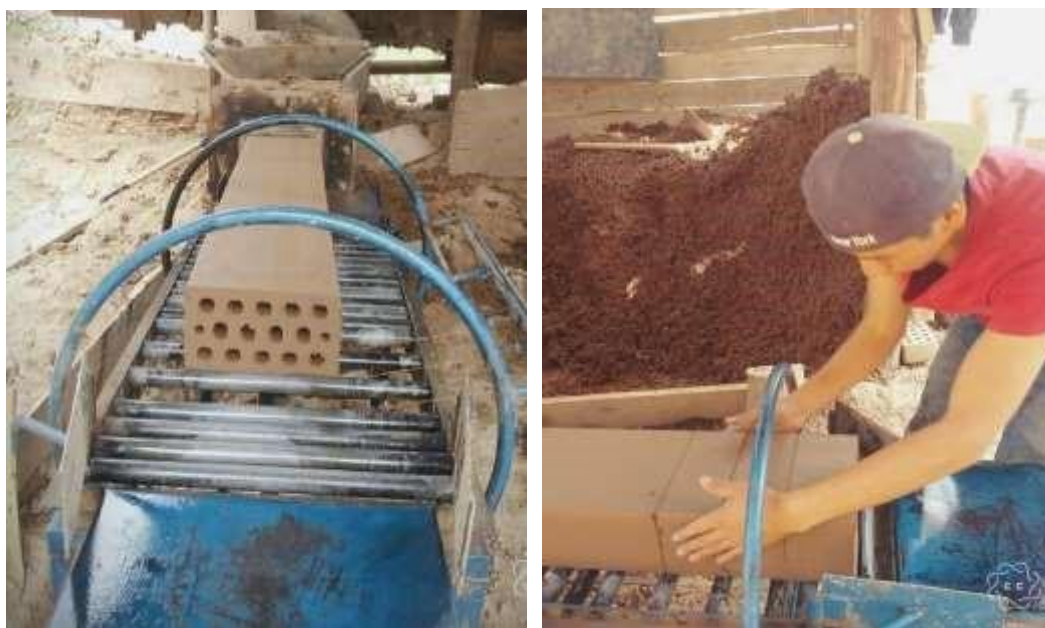
Figura V-10: Moldeo con extrusora
