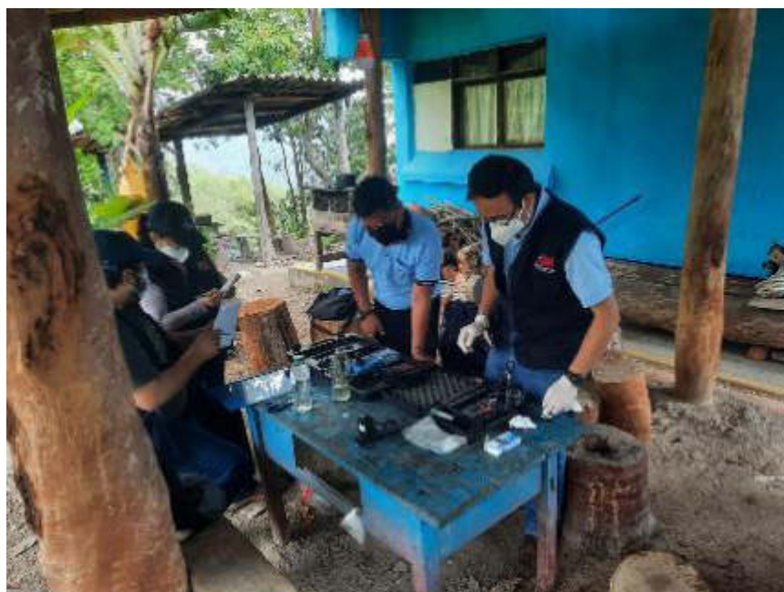
Fotografía 2 Se observa la recolección de muestras de agua, para el análisis físico, químico y bacteriológico por laboratorio acreditado Fecha: Nov-21
