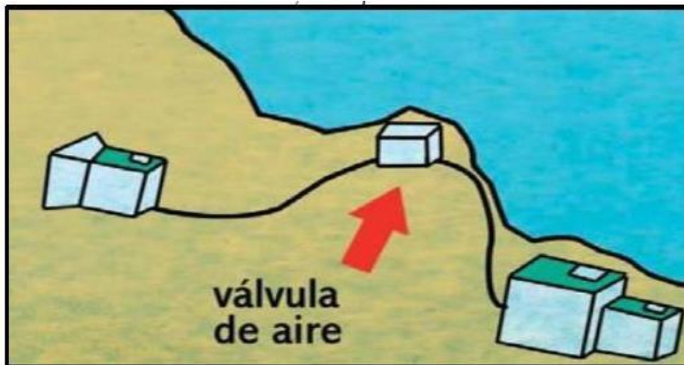
Figura 2: Ubicación de válvula de aire, en el punto más alto de la línea de conducción.
