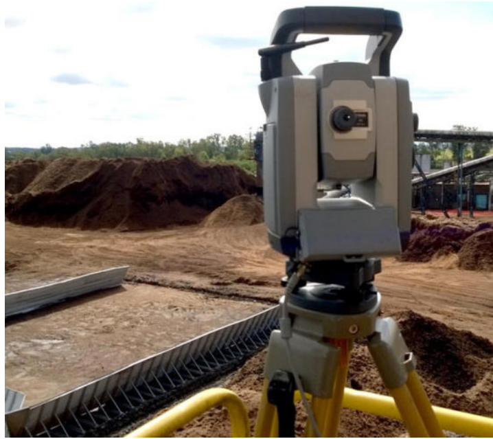
Fotografía N° 5 – Estación Total Trimble M3
