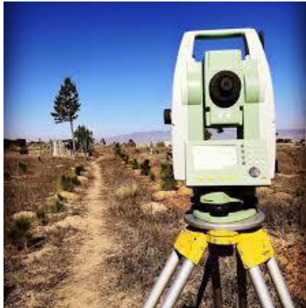
Fotografía N° 04 – Estación Total Leica TS06 Power.
