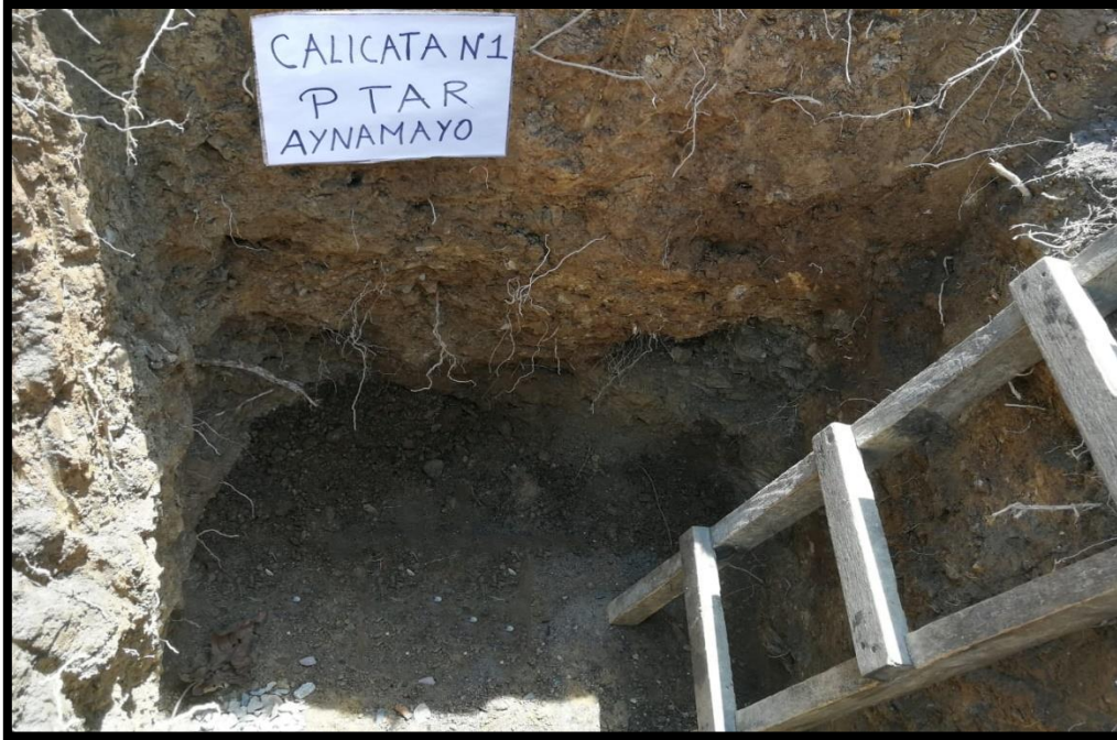
FOTOGRAFIA Nº 23- Calicata Nº 01 para la Planta de Tratamiento - Aynamayo
