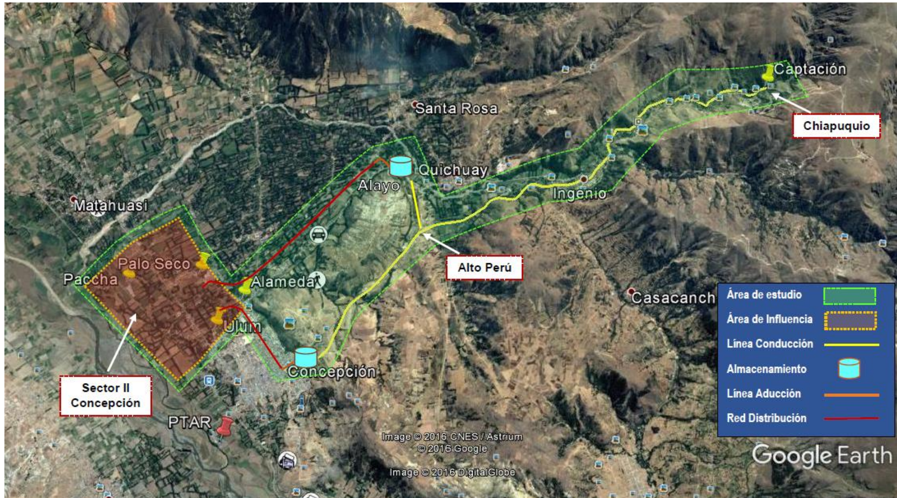
Figura 21: Esquema del Área de Estudio y Área de Influencia del Sistema de Agua Potable
