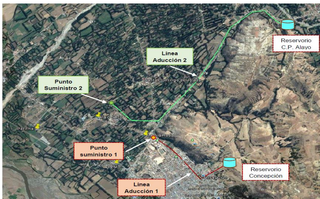
Figura 37: Esquema de las líneas de aducción – Sistema de AP
