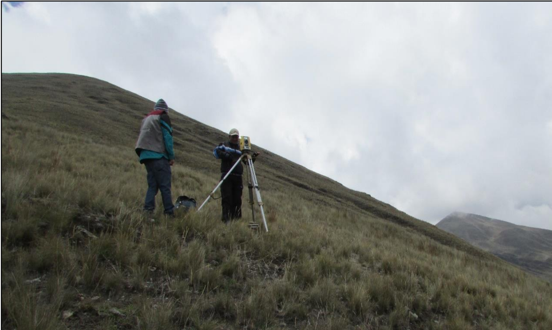
Fotografía 18: Levantamiento topográfico con estación total
