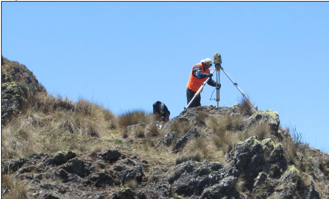
Fotografía 25: Instalación de estación total
