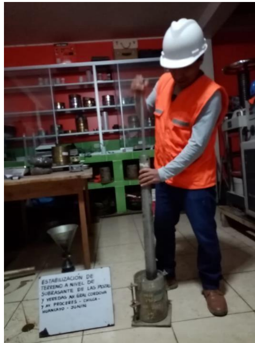
Figura 11: realizando la mezcla con % agua; realizando apisonado con el pistón
