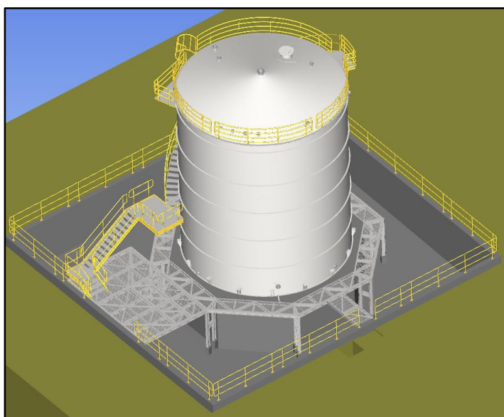
Figura 42. Imagen de esquema de instalación de barandas
