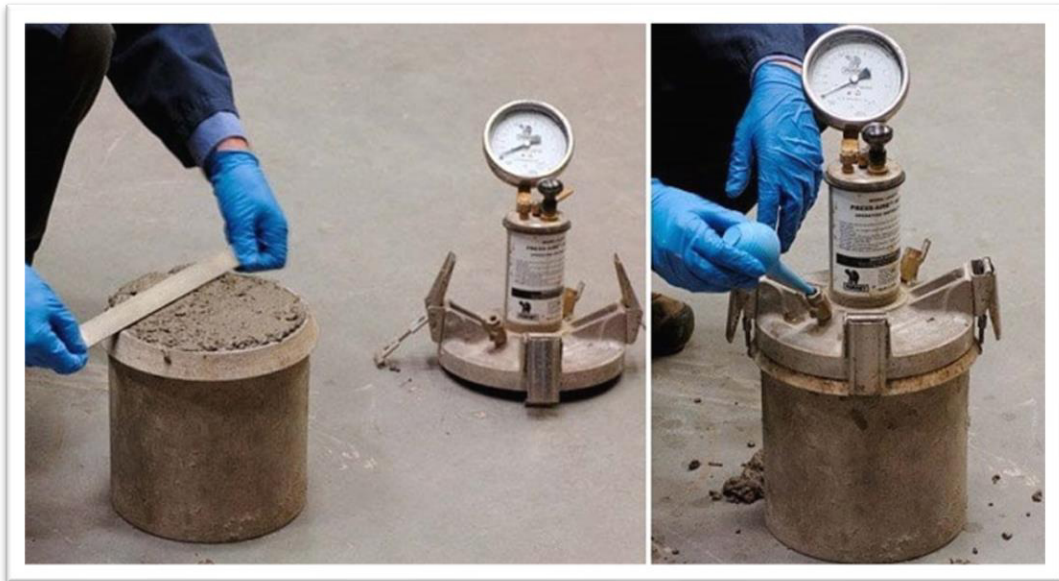
Imagen 3: Obtención de porcentaje de aire y rendimiento de concreto x m3.
