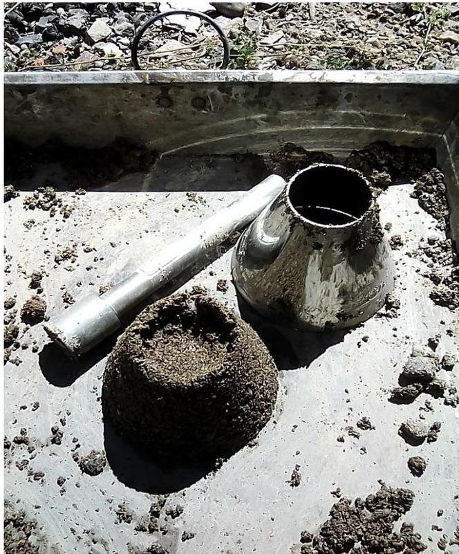
Fotografía N° 8 Cono de arena para peso específico agregado fino
