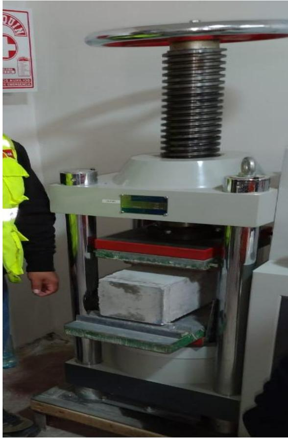
Fotografía N° 16 Ensayo de flexión de testigo viga
