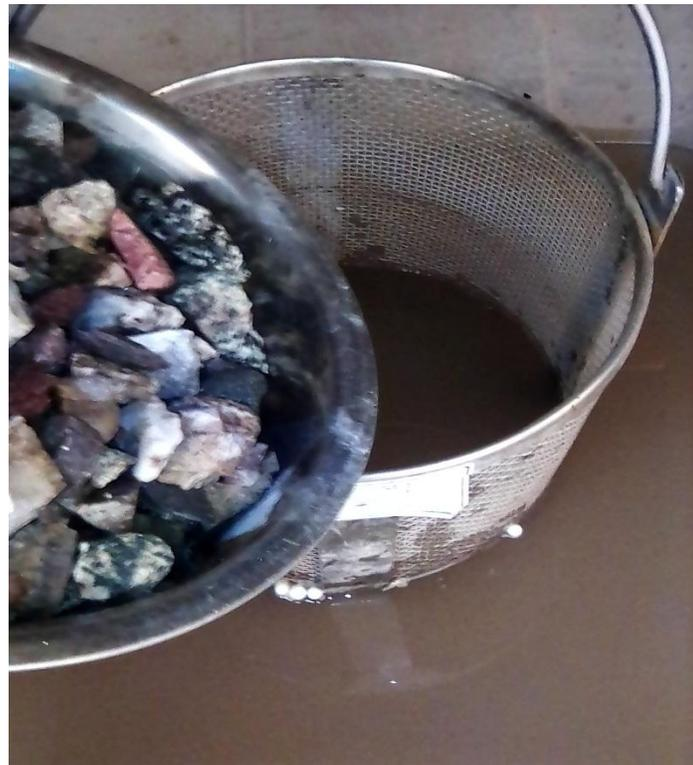
Fotografía N° 6 Ensayo de peso específico
