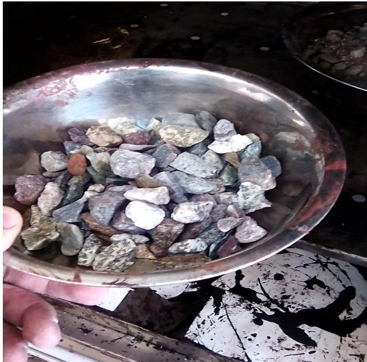
Fotografía N° 5 Humedad de agregado grueso
