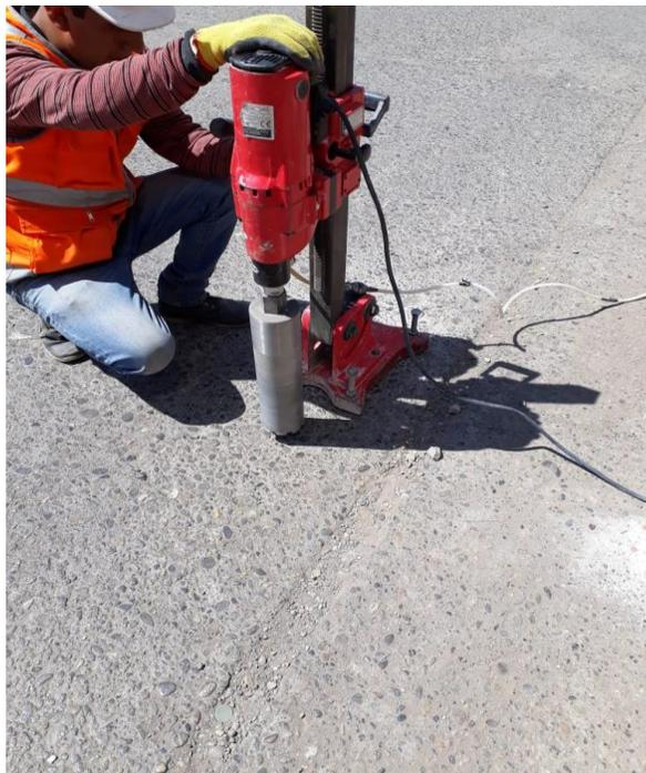
Fotografía N° 2 Extracción de diamantinas de concreto de la Av. Real
