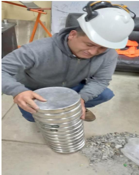
Fotografía N° 3 Granulometría de agregados
