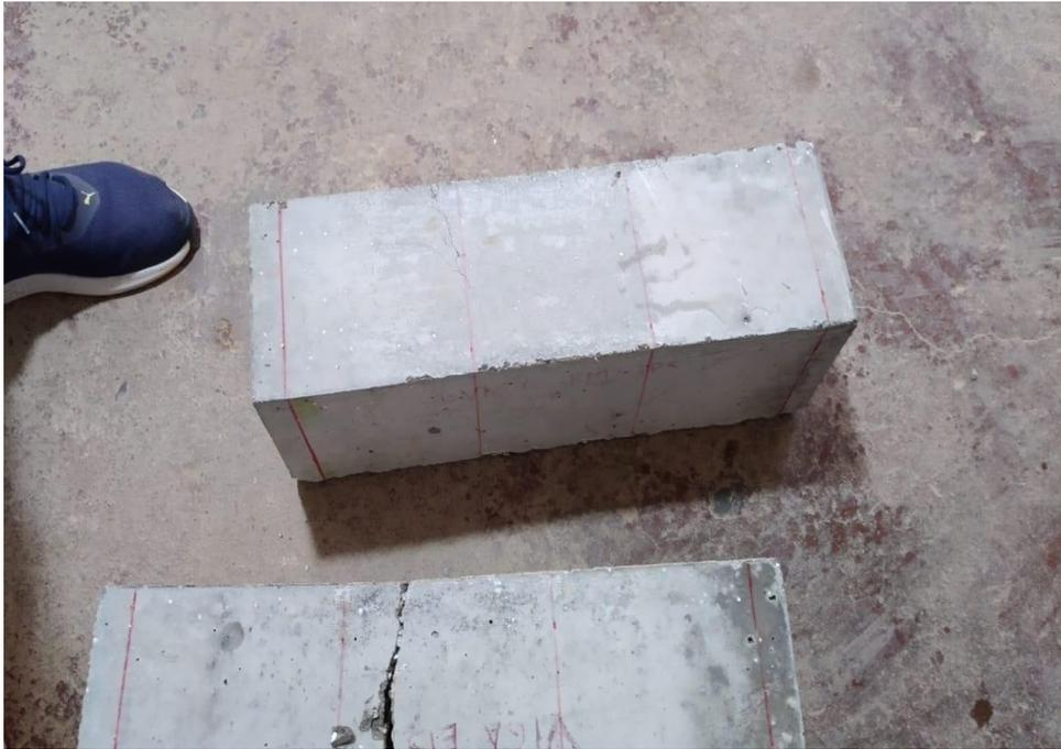
Fotografía N° 13 Testigo de viga para concreto
