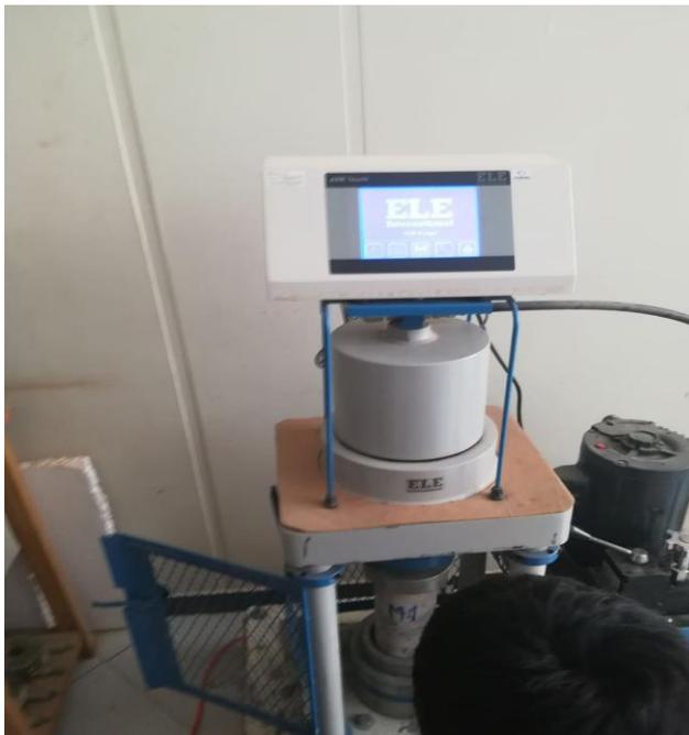
Fotografía N° 15 Ensayo compresión de testigos cilíndricos
