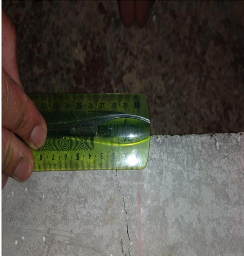
Fotografía N° 14 Falla en la viga por ensayo de flexión
