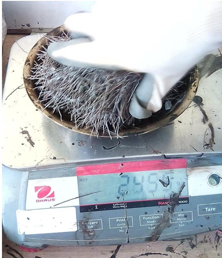
Fotografía N° 10 Fibra metálica tipo WIRAND FF1
