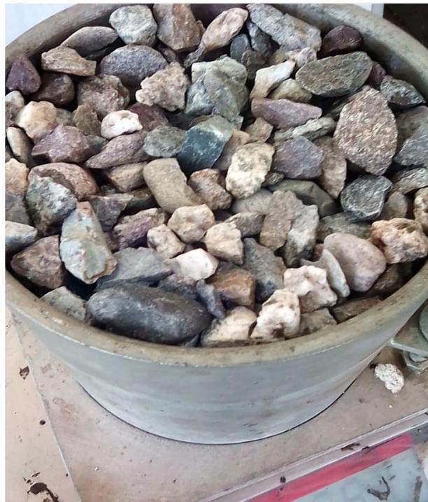
Fotografía N° 7 Peso unitario compactado de agregado grueso
