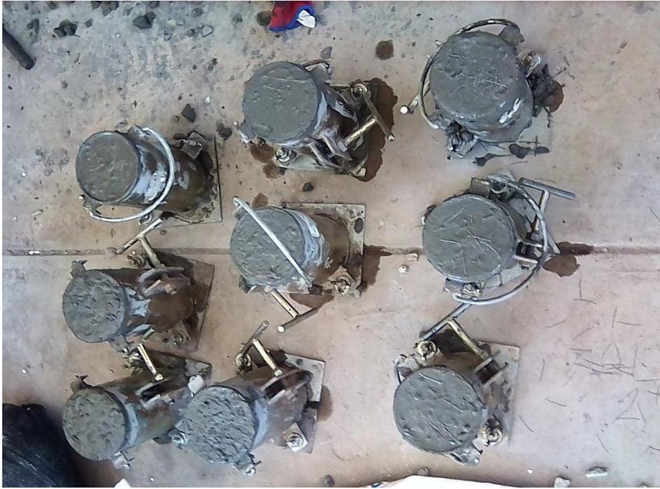
Fotografía N° 12 Testigo cilíndrico de concreto
