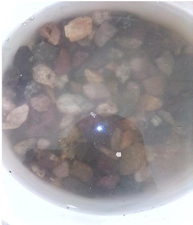
Fotografía N° 4 Muestra de agregado grueso para peso específico
