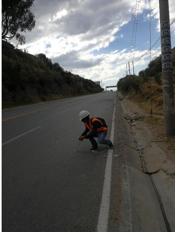
**Fotografía N°15:** Lectura de datos de la temperatura del pavimento
