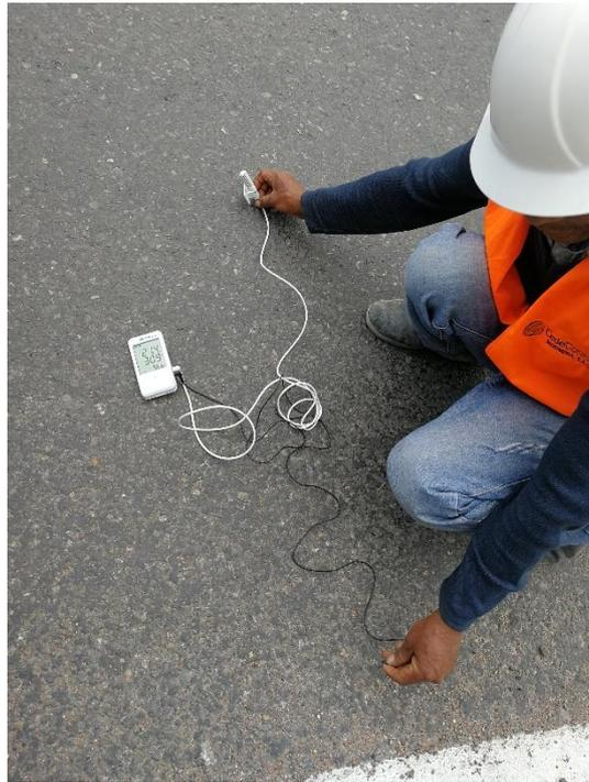
**Fotografia N°17:** Instalación de dispositivo para conocer la temperatura del pavimento
