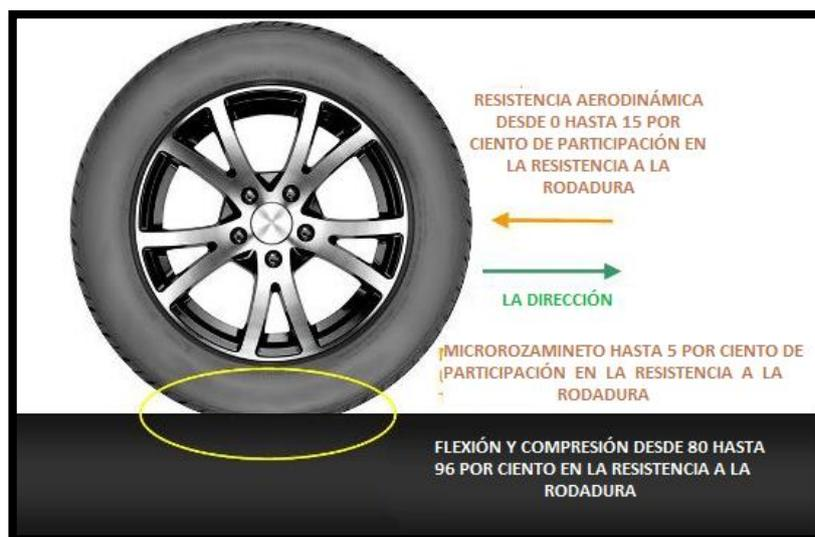
Figura N° 4: Flexión y Compresión entre neumático y pavimento
