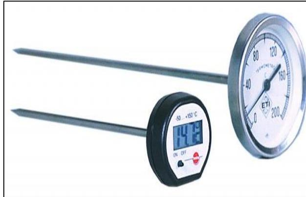
*Figura N° 10: Termómetro bimetalico*
