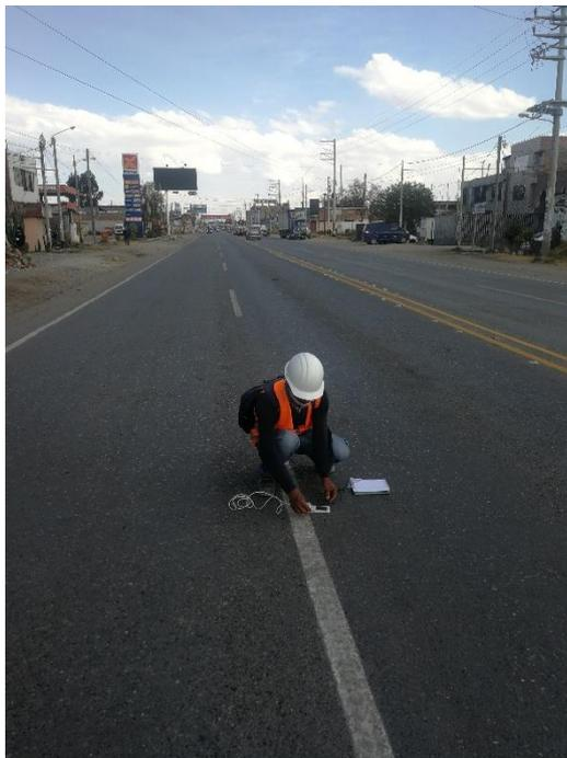
**Fotografía N°2:** Lectura de datos de la temperatura del pavimento
