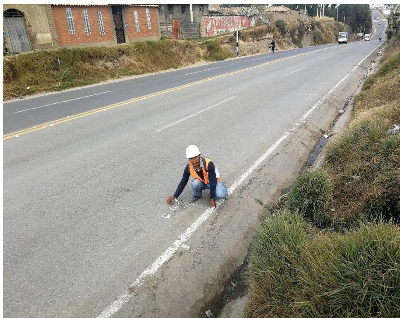
**Fotografia N°12:** Lectura de datos de la temperatura del pavimento
