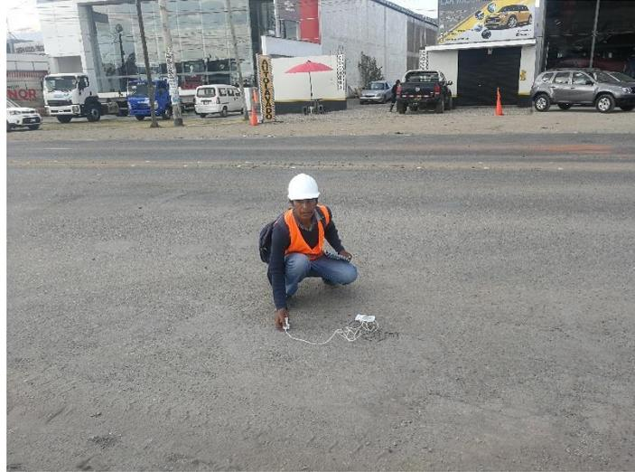
**Fotografia N°9:** Lectura de datos de la temperatura del pavimento
