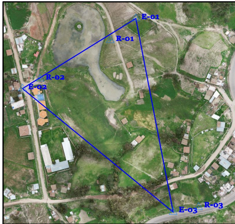
Figura IV-6: Ubicación de puntos de estación y referencia
