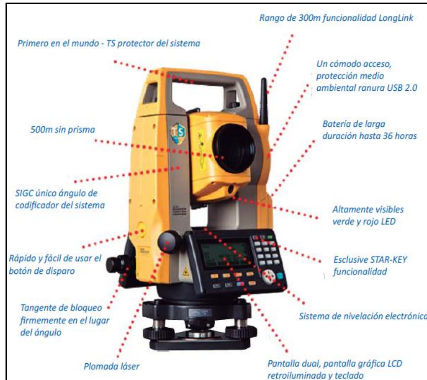
Figura II-2: Esquema de una estación total ES-105
