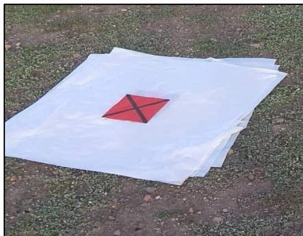
Figura IV-15: Lonas en puntos de control
