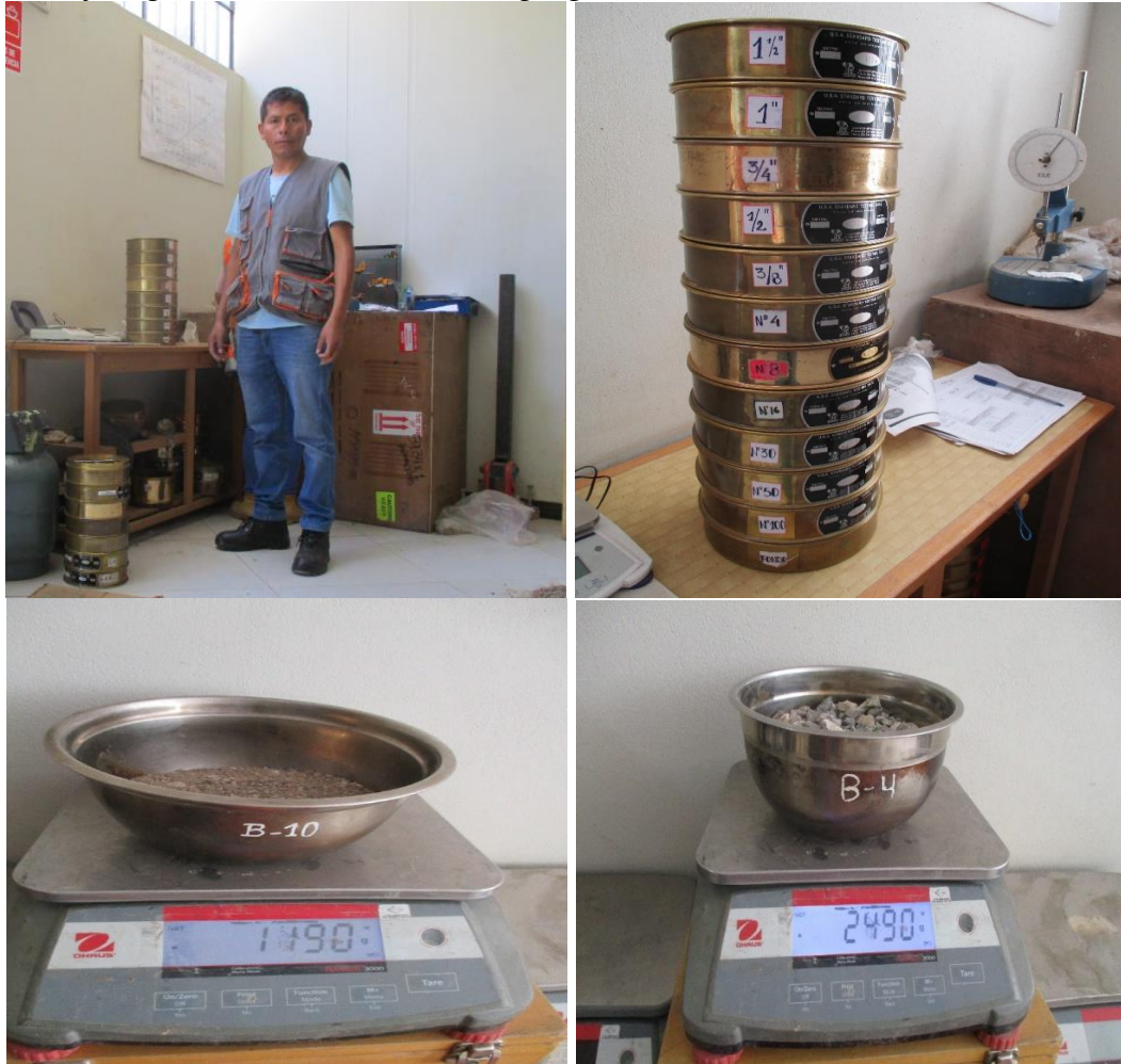
Fotografía 13 Ensayos granulométricos de los agregados
