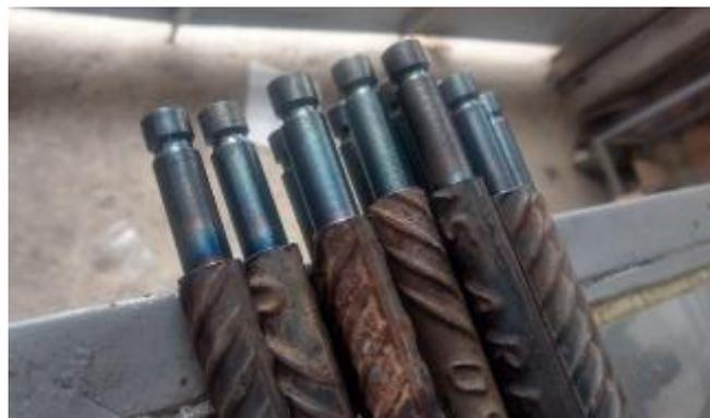
**Fotografía 1:** Anclaje de acero torneado para prisma Leica
