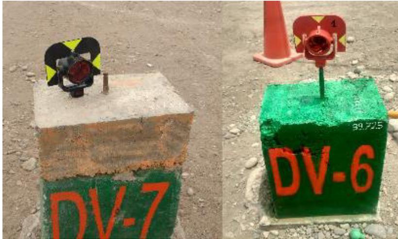
**Fotografía 2:** Hito de Concreto y anclaje de acero para prisma
