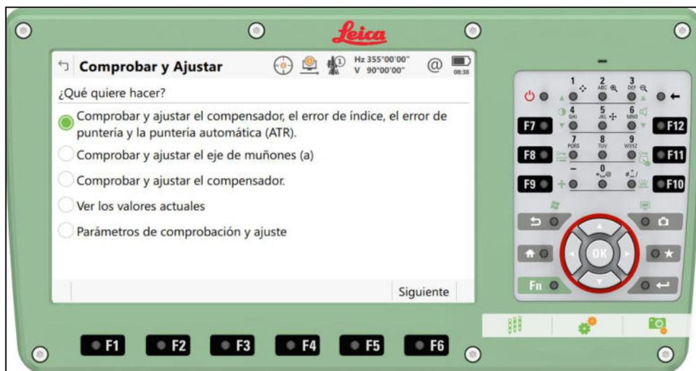
**Figura 6:** Comprobar y ajustar en Estación Total leica TS 16
