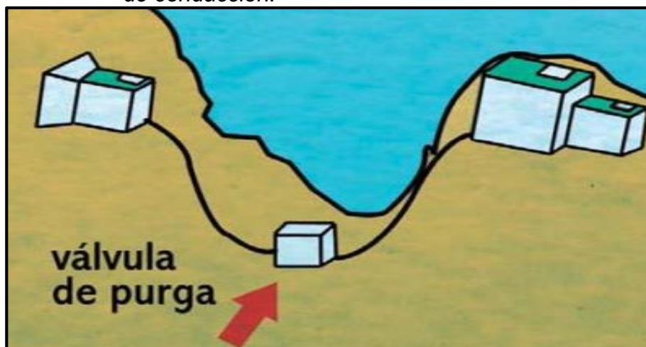
Figura 3: Ubicación de válvula de purga, en el punto más bajo de la línea de conducción.
