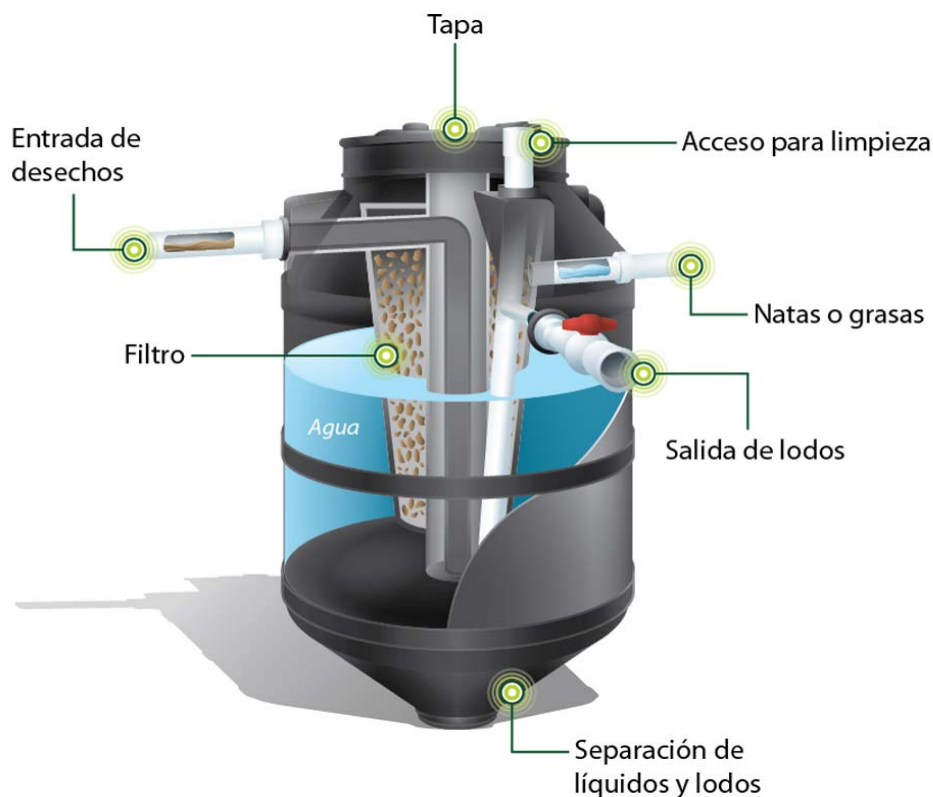
Figura 5: Detalle del sistema de unidad básica de saneamiento UBS
