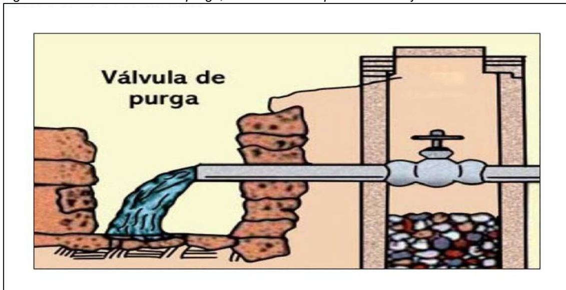
Figura 3: Detalle de válvula de purga, ubicados en los puntos más bajos de la línea de conducción.
