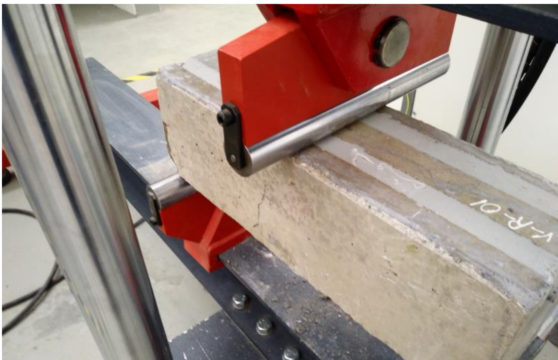
FOTO 15 Aparición de la Fisura en la probeta VR1. Carga de Rotura 60.258 kN, Resistencia a la Flexión 12.1MPa. Fuente propia.
