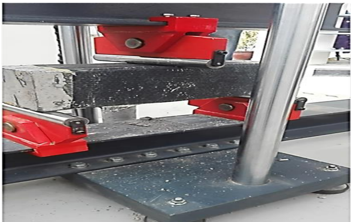
FOTO 19 Ensayo de Probeta VR3 Reforzado con Varillas, Lamina y Manta de FRP. Fuente propia.
