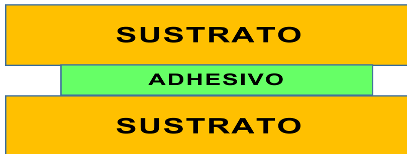
FIGURA 31 Esquema Básico de una Unión Adhesiva. Fuente Mario Madrid.
