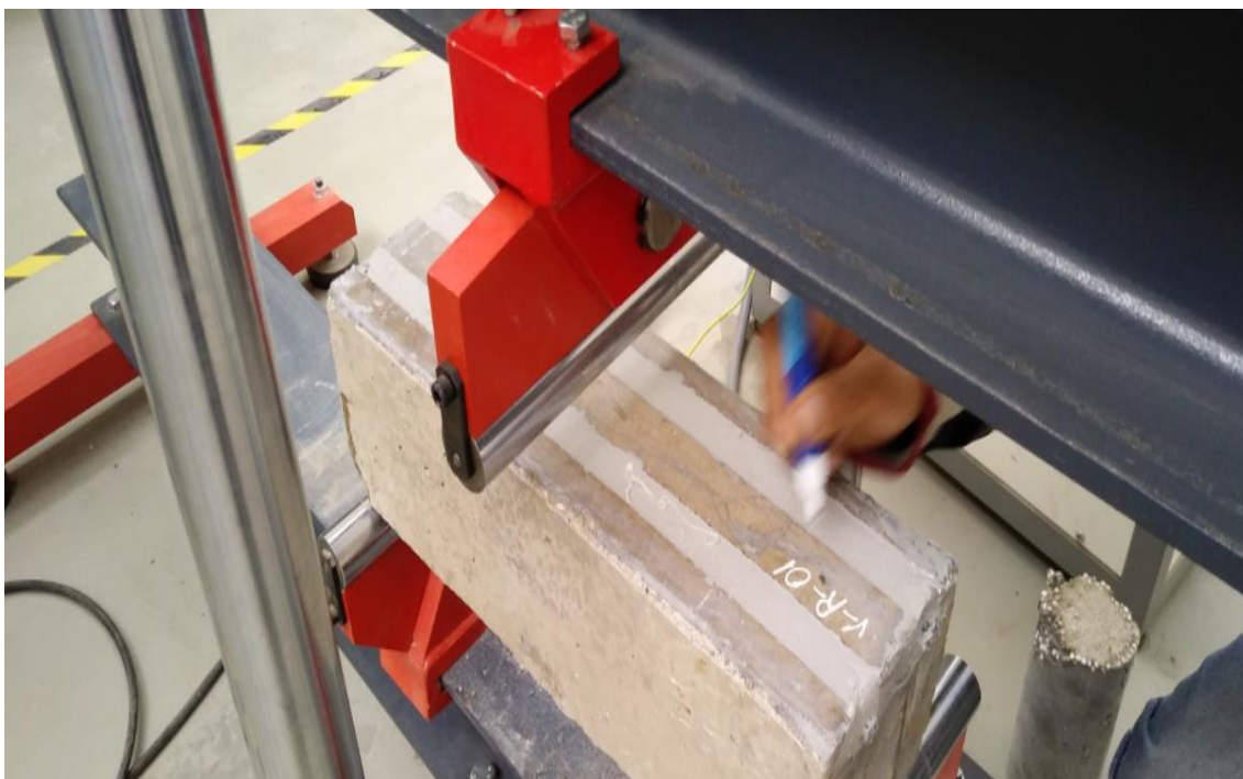
FOTO 14 Ensayo Probeta VR1 a Flexión, Reforzado con Varilla y Platina de FRP adherido al Concreto. Fuente propia
