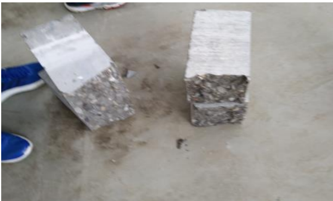
FOTO 13 Probeta VS3 fracturado a 20.492 kN, Resistencia a la Rotura 4.098 MPa. Fuente propia.
