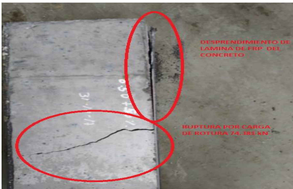
FOTO 18 Desprendimiento de la Lámina FRP y Fractura por Carga de Rotura 74.381 kN, a Resistencia de Flexión 14.9 MPa. Fuente propia
