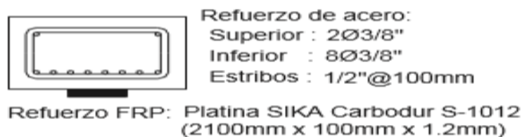
FIGURA 36 Viga 2B para Prueba de Flexión. Fuente Proaño Tataje.
