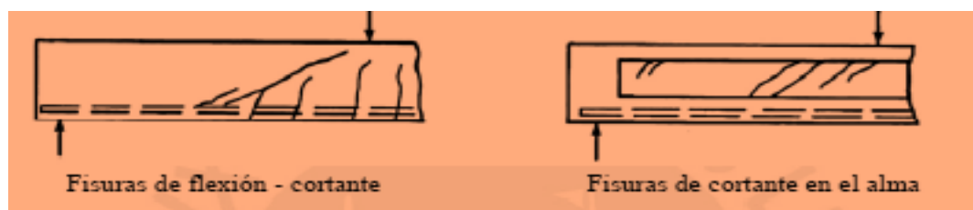
FIGURA 25 Fisuras por Flexión - Corte. Fuente Ottazzi Pasino.
