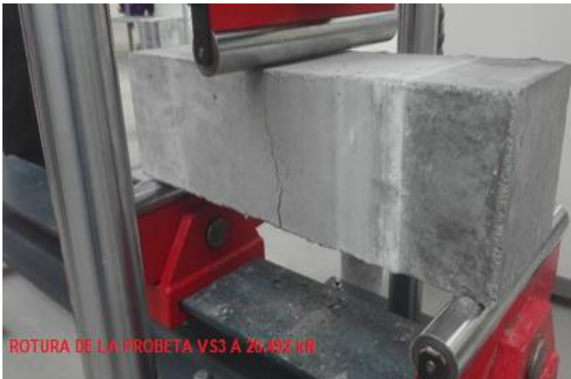
ENSAYOS CON PROBETAS REFORZADAS CON FIBRA DE CARBONO
