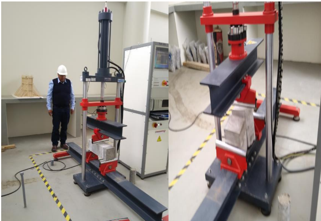
FOTO 11 Probeta Fractura Prematuramente se Desecha el Ensayo. Fuente propia
