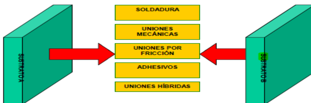
FIGURA 30 Posicionamiento de los Adhesivos Fuente Tecnología de la Adhesión. Fuente Mario Madrid.
