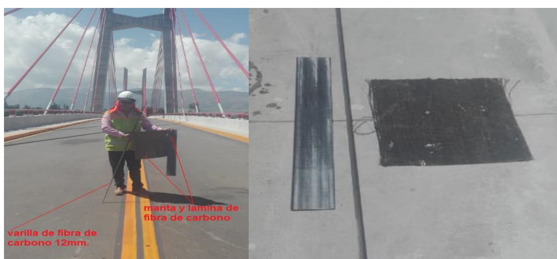
FOTO 6 Materiales que se Utilizaron para Reforzar las Probetas. Fuente propia.
