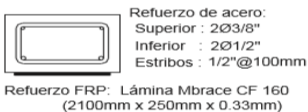
FIGURA 37 Viga 3A para Prueba de Flexión. Fuente Proaño Tataje.
