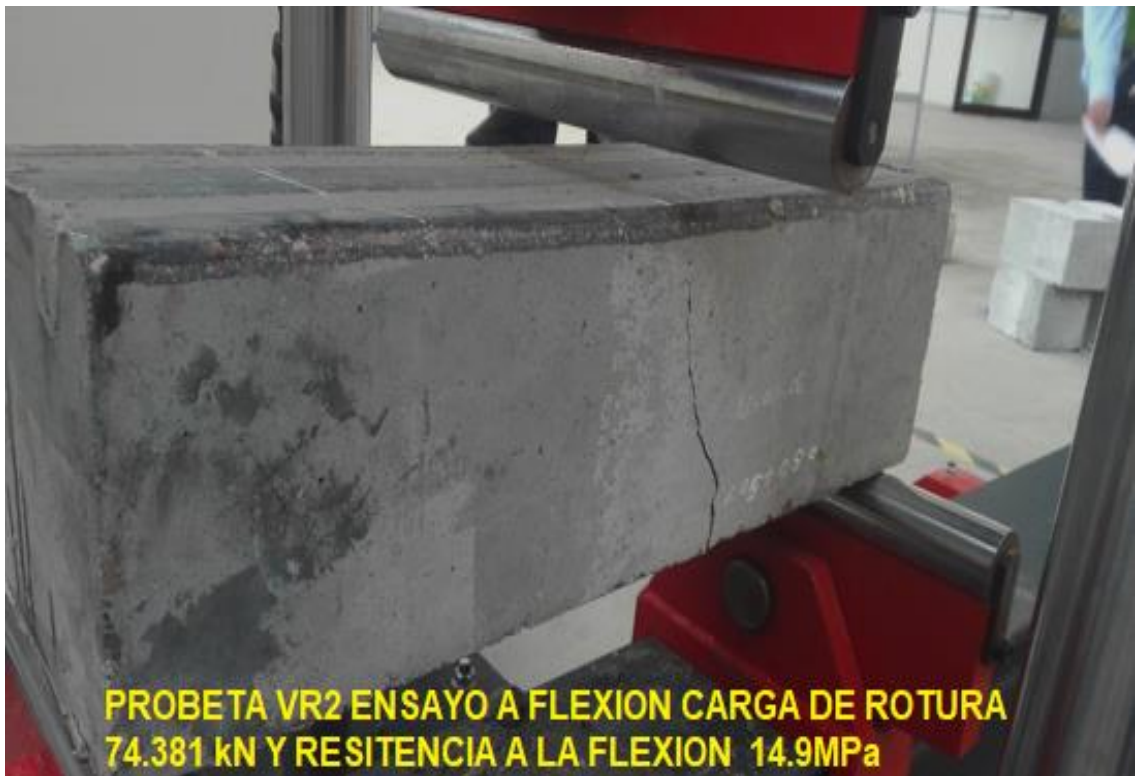
ENSAYO DE PROBETA REFORZADA CON FRP VR2
