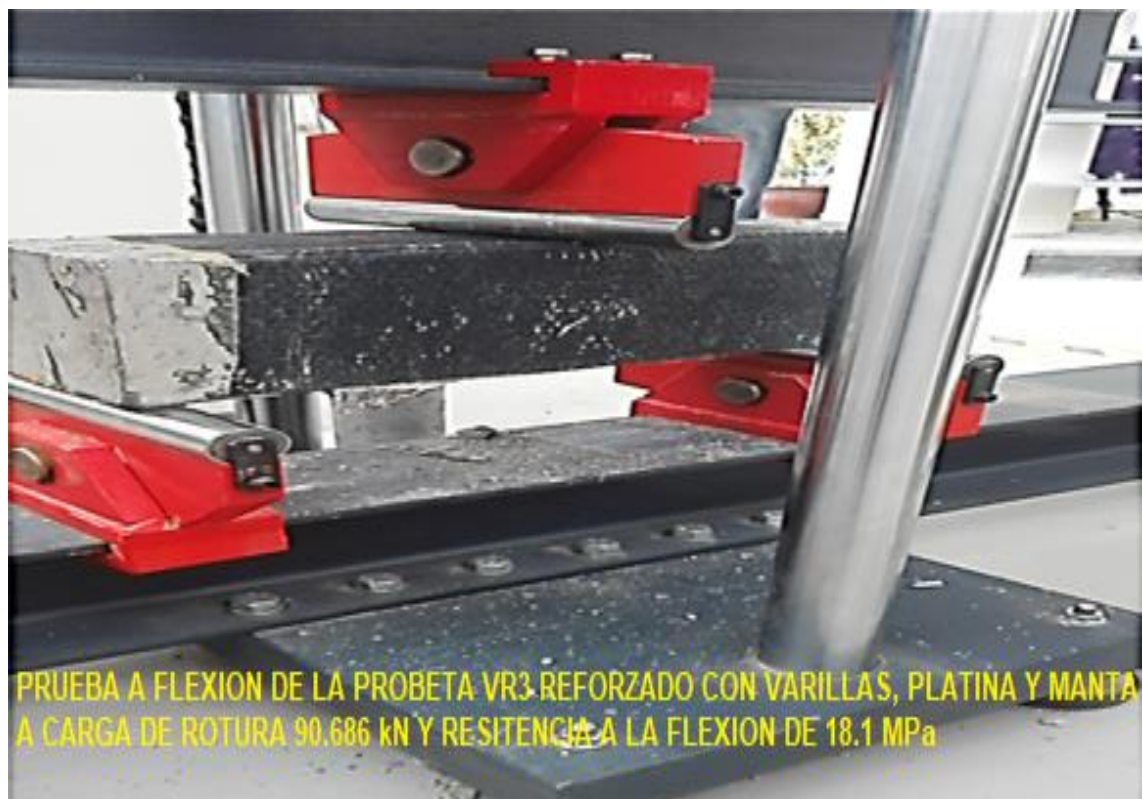
ENSAYO DE PROBETA REFORZADA CON FRP VR3.
