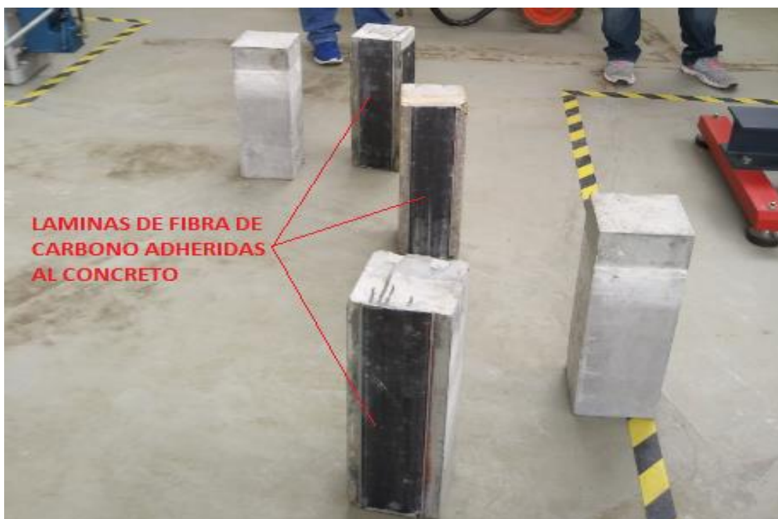
FOTO 9 Láminas adheridas a la Viga. Fuente propia
