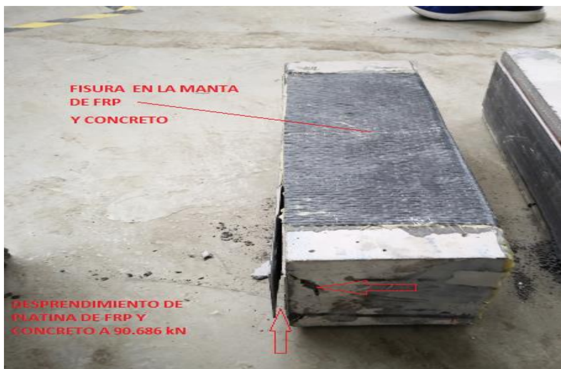
FOTO 20 Fisuras en el Concreto, Manta de FRP y el Desprendimiento de Platina de FRP asimismo del Concreto a 90.686 kN y Resistencia a la Flexión 18.1 MPa. Fuente propia.
