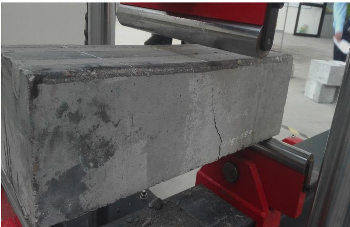
FOTO 17 Probeta VR2 Fracturado con Carga de Rotura 74.381kN y Resistencia a la Flexión 14.9 MPa. Fuente propia
