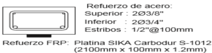
FIGURA 35 Viga 1 A para Prueba de Flexión Fuente Proaño Tataje.
